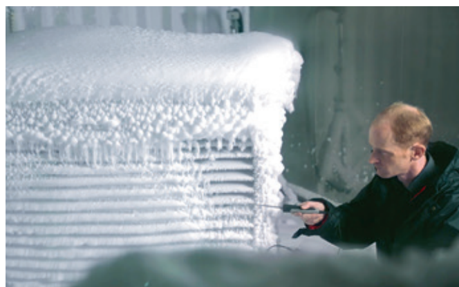
Komory klimatyczne symulują wszystkie potencjalne warunki eksploatacji
